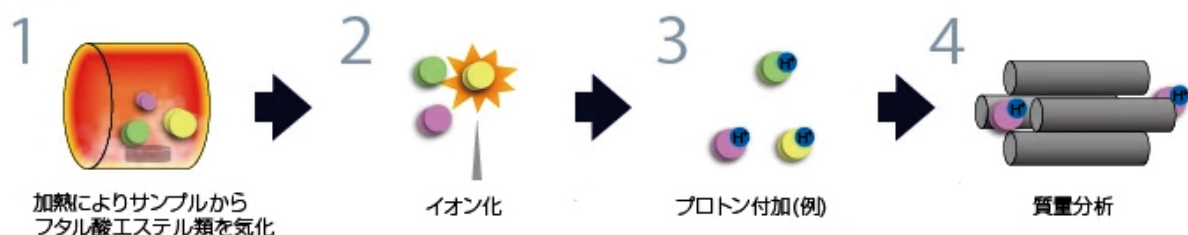
図1 ソフトイオン化を用いた質量分析計の原理
