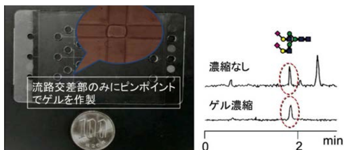
図1 アクリルアミドゲルのピンポイント作製と糖鎖の特異的高感度検出
