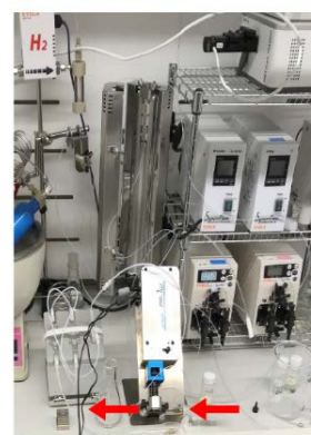
図1 フロー合成装置に接続した非接触計測用セルとラマン分光器
