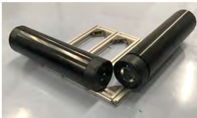
図 1：耐圧容器に収納したレーザー光源と検出部
