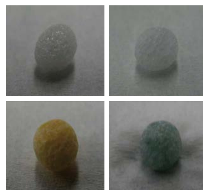
図2 抽出前(左)および抽出後(右)のセルロース微粒子(上段:未処理, 下段:キレート基導入)
